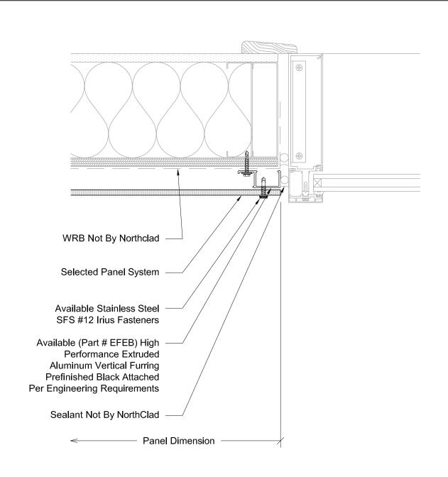
R Plan View - NorthClad EF - Window Jamb
